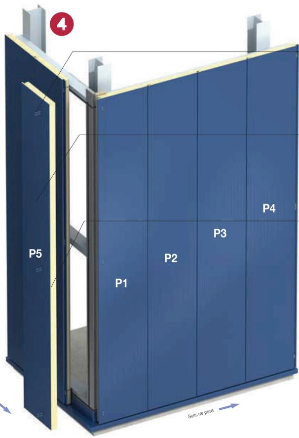
**r** Dans l'angle, fixer le panneau 5 (P5) à l'aide de 2 vis minimum. Couper le joint au niveau du montant vertical
